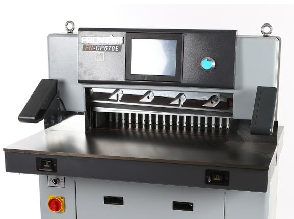
确认好尺寸后，就可以进行裁切，脚踩脚踏开关，压纸器开始压纸，两手分别按裁切按钮，压纸后开始裁切（也可以不踩脚踏开关，直接两手分别按裁切按钮，压纸器开始压纸，压纸后开始裁切），当发现有误时，松开按钮，刀和压纸器自动回位，确定无误后继续按住裁切按钮完成裁切第一刀尺寸。
