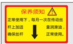
正常使用下，每月一次在传动部件、传动丝杆上加适量润滑油，确保机器正常使用。
