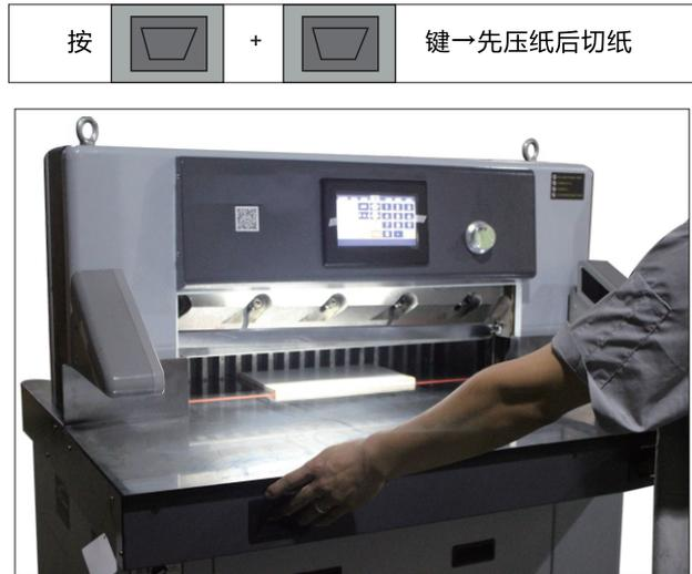
裁切完成第一刀后，推纸器自动推到下一刀的位置，继续按裁切键，依次按照设置顺序进行裁切，直至完成。
