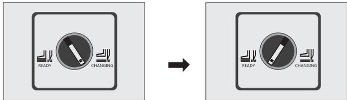
将两只拆刀螺杆依逆时针转半圈后向下取出刀片，请戴手套或用布包裹刀片，装入刀盒，以免划伤；
