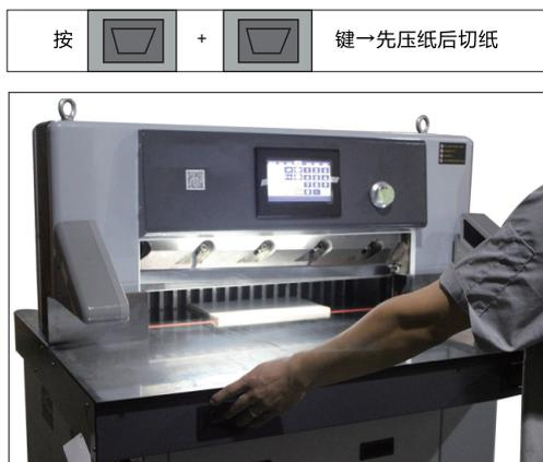
裁切完第一刀和第二刀后，再继续按裁切键自动回到第一刀60.0进行裁切，依次按照设置顺序进行循环和反复裁切，直至720的纸张完成裁切（在等分模式下自动推书无效）。
