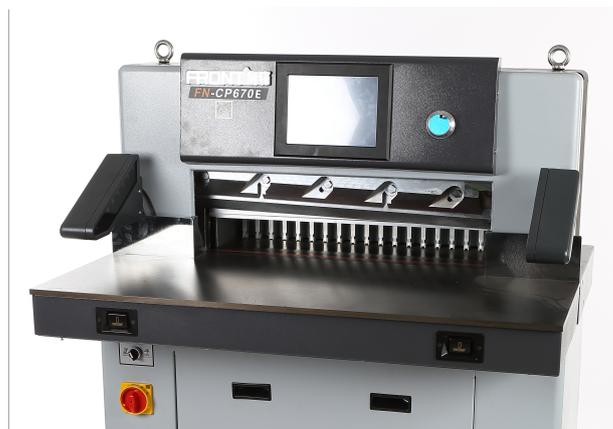
确认好尺寸后，就可以进行裁切，脚踩脚踏开关，压纸器开始压纸，两手分别按裁切按钮，压纸后开始裁切（也可以不踩脚踏开关，直接两手分别按裁切按钮，压纸器开始压纸，压纸后开始裁切），当发现有误时，松开按钮，刀和压纸器自动回位，确定无误后继续按住裁切按钮完成裁切第一刀60.0的尺寸，再继续按裁切键裁切第二刀110.0mm的尺寸。
