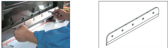
取出一片新刀片，注意安全，刀锋朝外，将两根拆刀螺杆拧在刀片开口孔内，再把刀片装在刀架上，依次用螺丝拧紧固定，然后根据切入深度调节方法进行调节。
