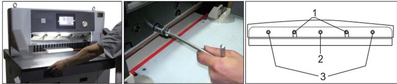
取下刀架上的其他锁紧螺丝，2号螺丝除外；
