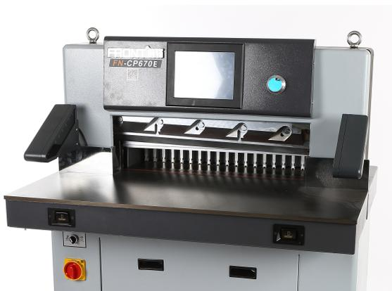
确认好尺寸后，就可以进行裁切，脚踩脚踏开关，压纸器开始压纸，两手分别按裁切按钮，压纸后开始裁切（也可以不踩脚踏开关，直接两手分别按裁切按钮，压纸器开始压纸，压纸后开始裁切），当发现有误时，松开按钮，刀和压纸器自动回位，确定无误继续按住裁切按钮完成裁切。
