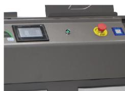
**急停开关：**当出现危险或危急的情况时，应该立刻按下应急开关，机器将停止除加热器外的一切功能。**取消急停：**按照开关上的箭头方向旋转上升即可，机器重新启动。
