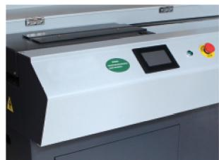
3. 通电。将机器电源插头正确连接在电源插座上，注意接线板的功率与机器功率是否匹配，以免出现意外情况，打开机器电源开关。
