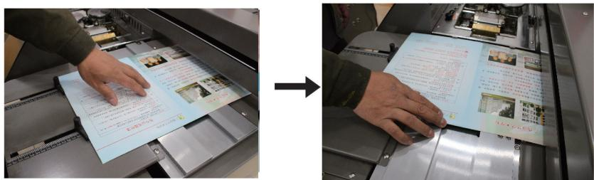
4. 放置内页，按夹本小车松开/夹紧开关，将内页上下、左右整理平整放入夹本台内，左对齐，按松开/夹紧开关，将内页夹紧，如图：
