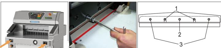
取下刀架上的其他锁紧螺丝，2号螺丝除外；
