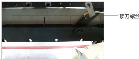
把换刀开关由换刀状态转向正常状态，切刀回位。
